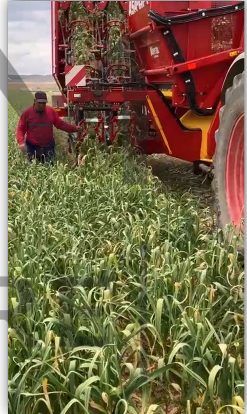
Recolectora de corte autopropulsada con tolva
